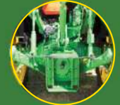
ยกน้ำหนักอุปกรณ์ติดตั้ง 2500 กิโลกรัม
