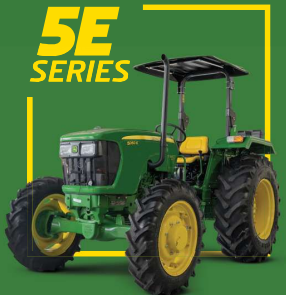
ยกน้ำหนักอุปกรณ์ติดตั้ง 2500 กิโลกรัม
